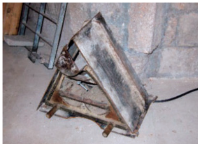
Fig.48)* 正三角形のプレキャストコンクリート型枠（スチール）2010.
