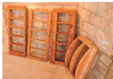
Fig.49)* コンクリート・ブロック型枠(木製), 2010.
